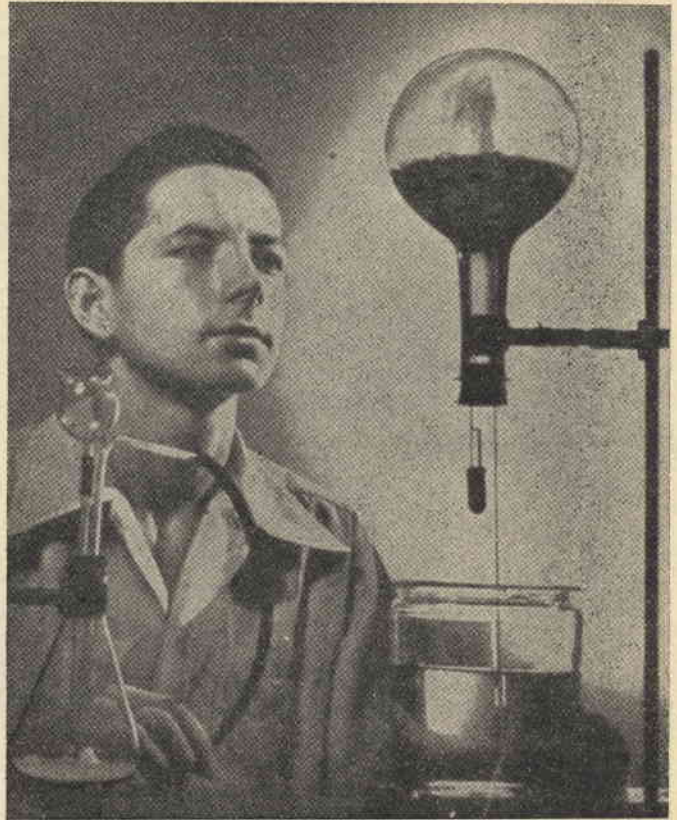
Ammoniaca allo stato gassoso si scioglie in un po' d'acqua introdotta nella fiasca, generando un vuoto parziale, ma sufficiente ad innescare la piccola fontana. A sinistra il generatore di ammoniaca.
